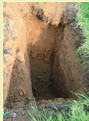
Sondages à la pelle mécanique dans des matériaux limoneux (Source Cerema)
