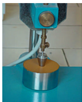
Figure 9 Détermination de la limite de plasticité au cône (à gauche) et à la coupelle de Casagrande (à droite) (Source Cerema)
